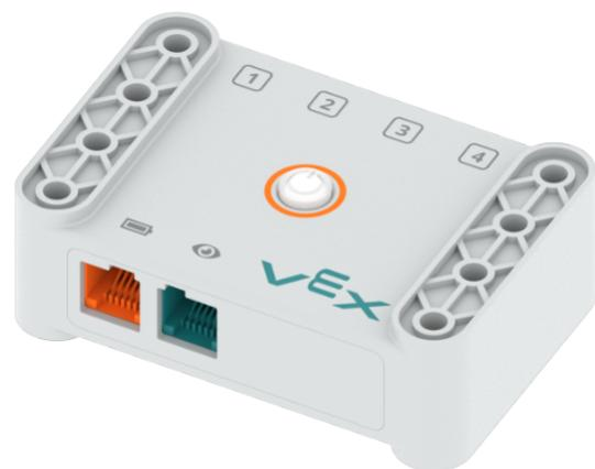
El **cerebro** es esencial para cualquier proyecto de VEXcode GO. El cerebro controla los dispositivos que le conectamos. Tiene cuatro puertos numerados que pueden aceptar motores, parachoques LED o electroimán. También tiene dos puertos separados para la batería y el sensor ocular.
