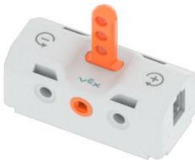
El **interruptor**: cuando está conectado a un motor, controla la dirección en que gira el motor. El interruptor se puede configurar para avanzar, retroceder o apagar.
